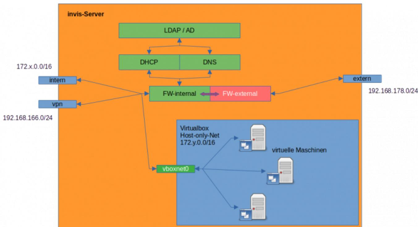
Durch die Integration der VMs in ein eigenes Subnetz, welches aus Sicht von Virtualbox als „Host-only-Subnetz“ sichtbar ist, teilen sich nicht mehr der invis-Server selbst und alle VMs die physische interne Netzwerkschnittstelle, wie es mit Netzwerkbrücken der Fall ist. Dadurch werden „Hänger“ beim Zugriff auf die VMs vermieden und sie reagieren deutlich schneller auf Anfragen.
