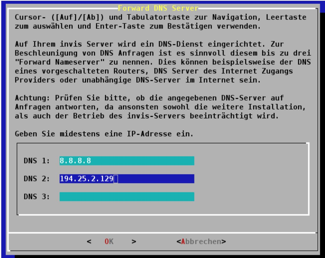
Ein invis-Server arbeitet für das an ihn angeschlossene Netzwerk als DNS-Server. Zuständig ist er primär für die Namensauflösung im lokalen Netz, er arbeitet aber auch als Caching-Nameserver für die Namensauflösung im Internet. Um diese Aufgabe zu erleichtern können ihm sogenannte „Forwarder“ bekannt gemacht werden. Forwarder sind DNS-Server, die die Namensabfrage im Internet beschleunigen können. Das Setup-Script fragt nach bis zu drei Forward-DNS Servern. Sie
