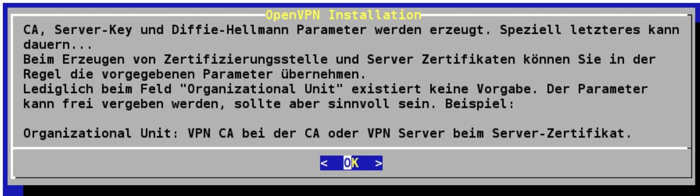
Sinnvoll ist dies, weil die Erzeugung von Schlüsseln und Zertifikaten für openVPN-Server und Clients mit anderen Vorgaben geschieht als bei den Schlüsseln für den Rest des Servers. Zum Einsatz kommt hier „easyRSA“ ein leicht zu handhabendes Werkzeug zur Verwaltung der Schlüssel.
