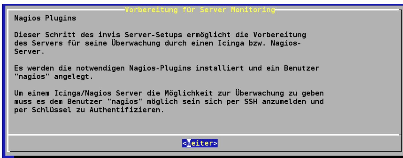
Zusätzlich zur Installation der Plugins wird ein Benutzer namens „nagios“ angelegt, der für den Zugang eines Monitoring-Servers genutzt werden sollte.
